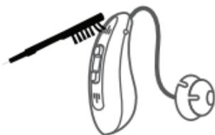
Extraiga los domos de los receptores de los audífonos. Utilice el cepillo suministrado para limpiar el interior del domo y alrededor del vástago. Limpie el domo con un paño suave y húmedo o con agua y jabón neutro. Asegúrate de que el domo esté completamente seco antes de colocarlo en el vástago.
