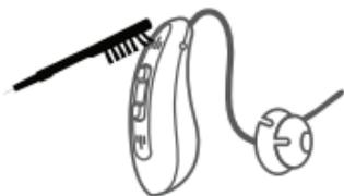
Extraiga los domos de los receptores de los audífonos. Utilice el cepillo suministrado para limpiar el interior del domo y alrededor del vástago. Limpie el domo con un paño suave y húmedo o con agua y jabón neutro. Asegúrate de que el domo esté completamente seco antes de colocarlo en el vástago.
